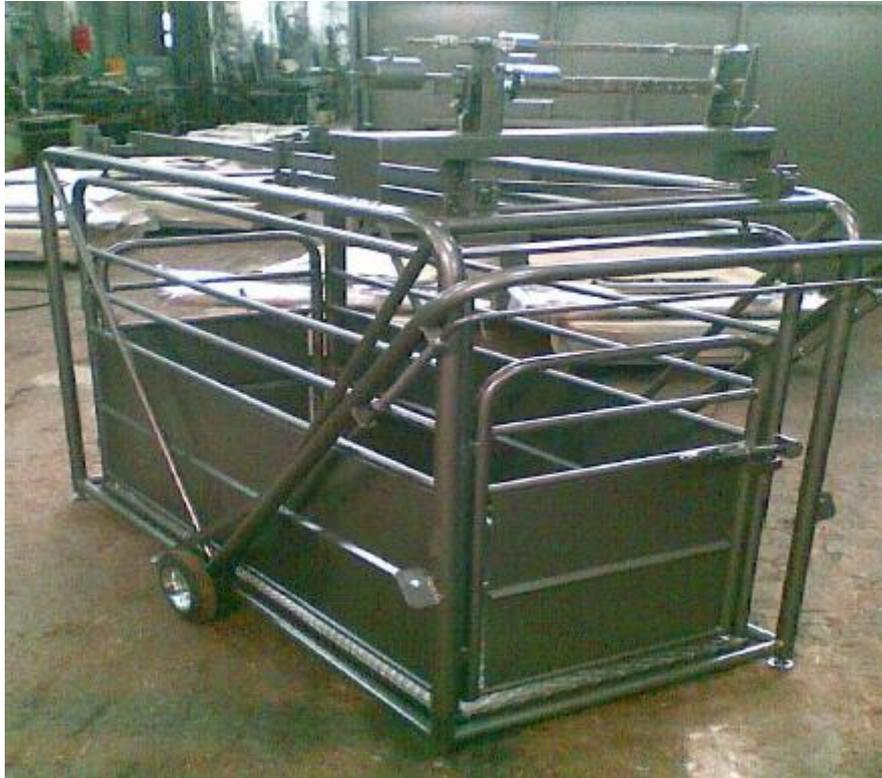
Esta balança é totalmente metálica, equipada com alavanca de suspensão para imobilização do estrado. Equipada com duas portas equipadas com fechos de segurança com mola tensora segurança com mola tensora, trancando automaticamente a porta. Esta balança possui rodas e é facilmente transportada por uma pessoa. A leitura do peso é efetuada por escala romana em Aço Inox. Com capacidades de 300 e 500Kg esta balança pode ser construída nas seguintes medidas: 1,45X0,60
