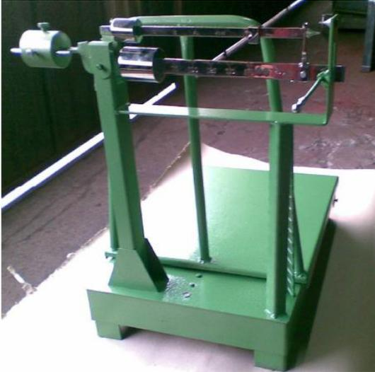
Balança inteiramente metálica. O chassis é construído por alavancas independentes manufaturadas em chapa de aço trabalhando a cutelo. Navalhas e moentes em aço especial. O aparelho de leitura é do tipo romano com leitura em escala de Aço Inox graduadas em máquinas da mais alta precisão. São construídas em Ferro Pintado ou em Aço Inox.
